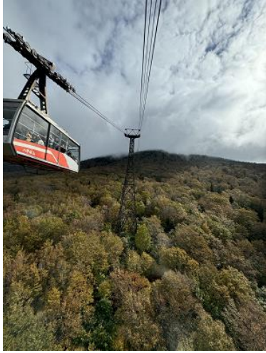
複線交走式普通索道方式のロープウェイ 途中でゴンドラがすれ違う
