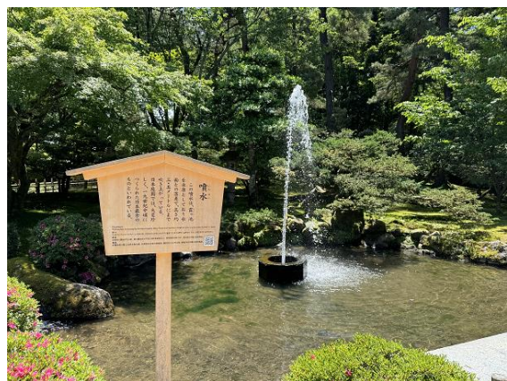
日本最古の噴水。霞ヶ池からの水圧だけで3.5m上がっている
