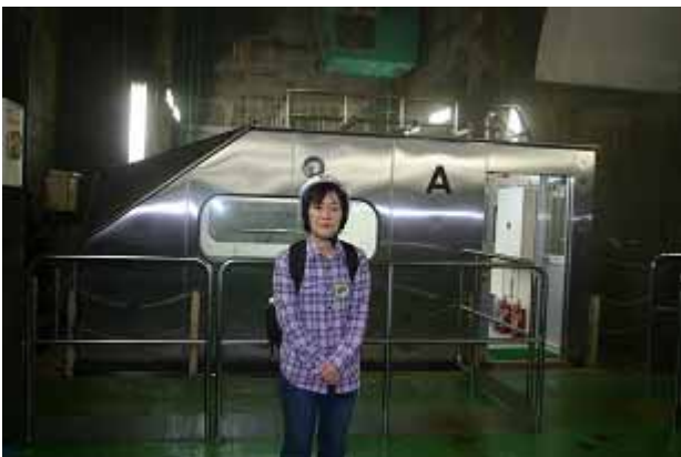
インクラインとは、工事用のケーブルカー。傾斜角度 34 度、斜距離 815m を立山ケーブルカーと同様に 2 台のケーブルカーをツルベ方式で動かしている。
