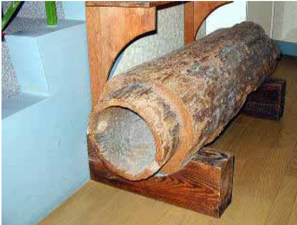
昭和初期から昭和 30 年頃まで使用されていた引湯管（赤松材をくり抜いた 8 インチ木管）。
