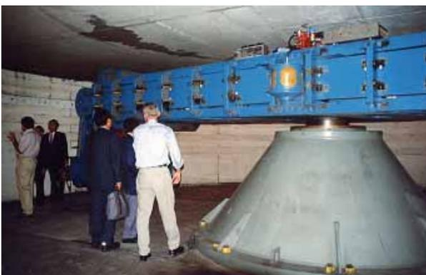
写真 2 コロラド大学の遠心力载荷装置
