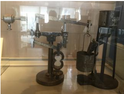
写真-13 ミハエリス二重てこ式抗張力試験機
