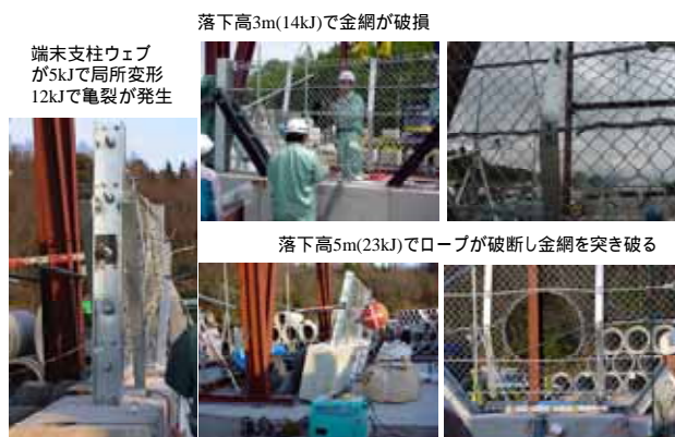
写真3 落石防護柵の変状 10)
