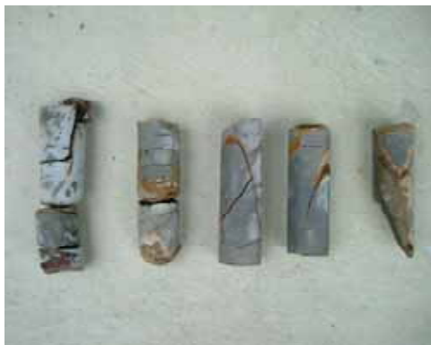
写真-2 岩盤から採取したコア
