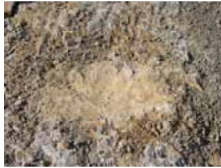
岩盤の変形による窪み(落下高4m) 窪みの直径14~15cm, 深さ1cm
