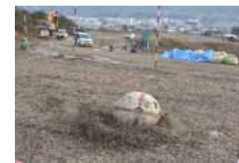
球が右にロッキングを継続。付近の土が飛散する。
