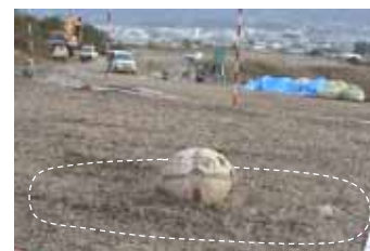
衝突と同時に破線の範囲の地盤が浮き上がる。その後球が右方向にロッキングを開始する。
