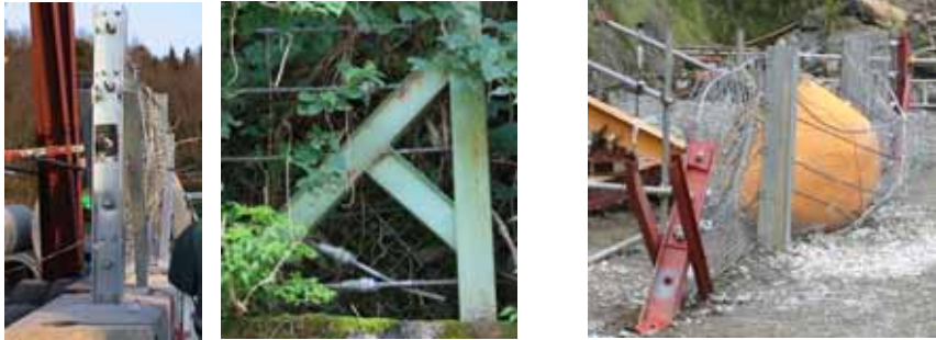
端末支柱のウェブが局部破壊 引付棒が破断 端末支柱と斜材の連結部の強度不足
