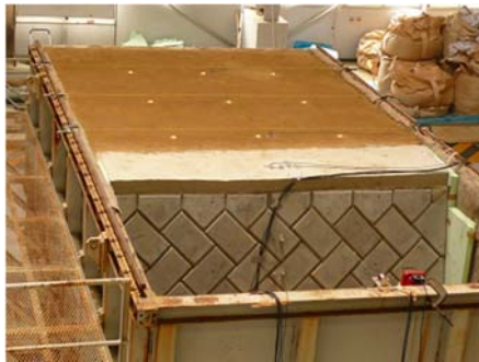
200gal加振後 擁壁の変位を確認できない。
