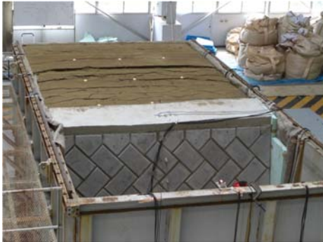
818gal加振後 擁壁が前方へ3度回転。盛土内にすべり面が発生。 大きなすべり面角度は45度。
