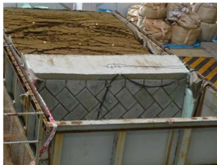
1000gal加振後 大きく前方へ回転。すべり面の角度は30度以下。
